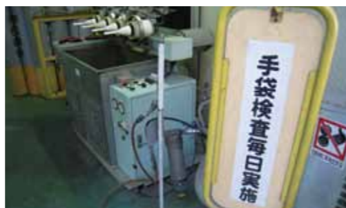
手袋検査機 作業時に使用する手袋に穴あきや破損がないか、作業前に手袋検査を行っています。
