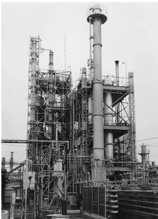
わが国初のパークロールエチレン 製造設備(アセチレン法)
